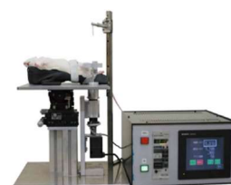
図2 小動物用足関節運動装置
